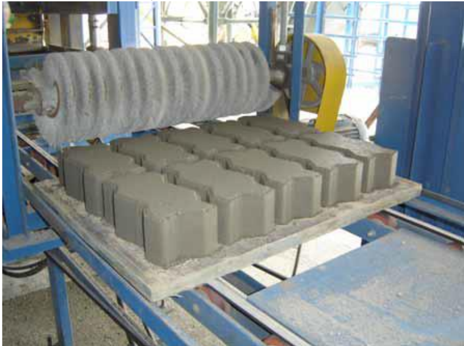
Figura 05 - Fabricação com máquinas vibro-compressoras
