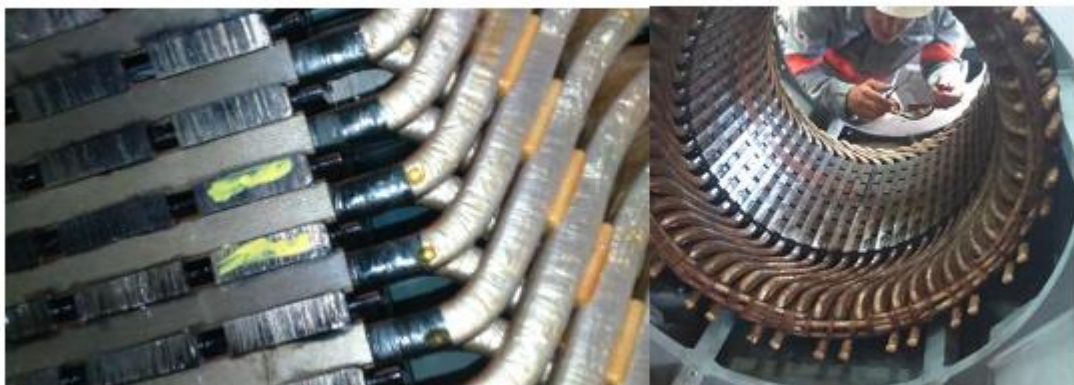
FIGURA 2: Ranhura do Motor danificada
